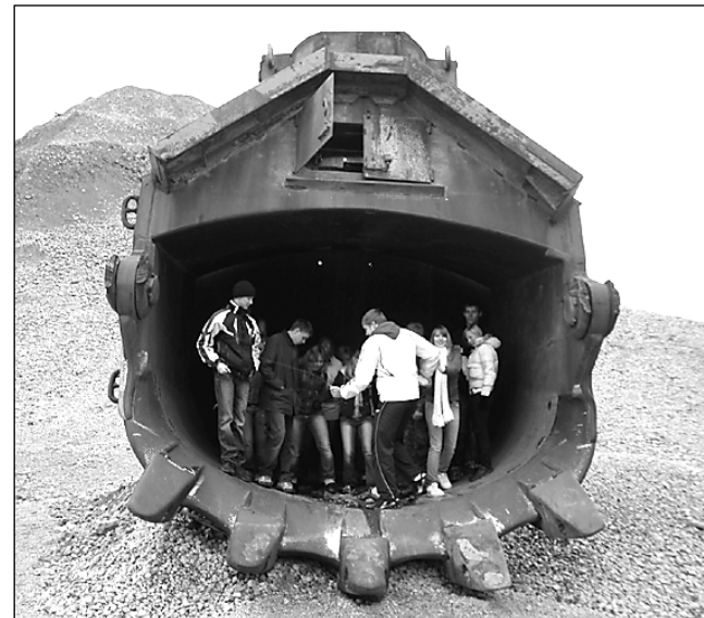
Sellise ekskavaatorikopaga tõsteti põlevkivi kalluritele.
